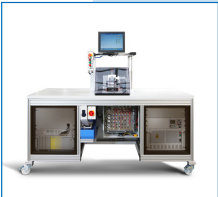
Universalprüfstand mit eingebautem ELMeS™ Hochspannungsprüfgerät DC
