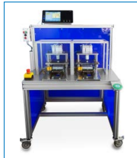
DiMeS™ im Einsatz als Steuer- und Prüfeinheit
